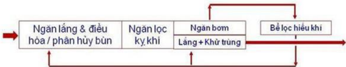
Hình 3.2: Sơ đồ nguyên lý hoạt động của bể Bastafat
